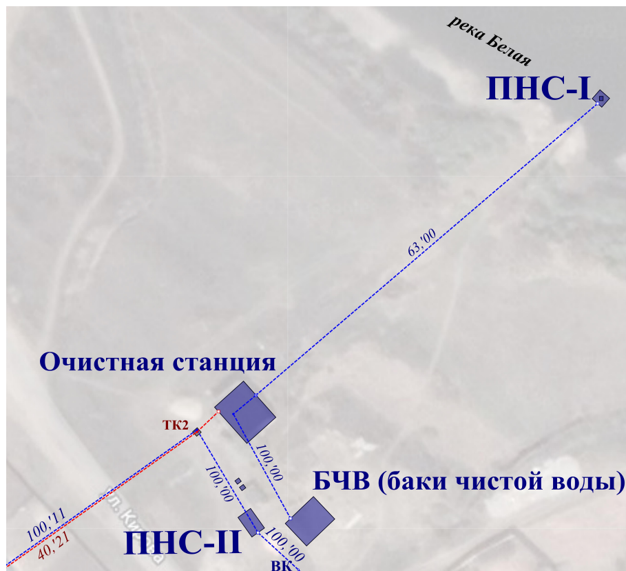
Рис. 1.2. Принципиальная схема Водозабора «Струя» с. Мальта
