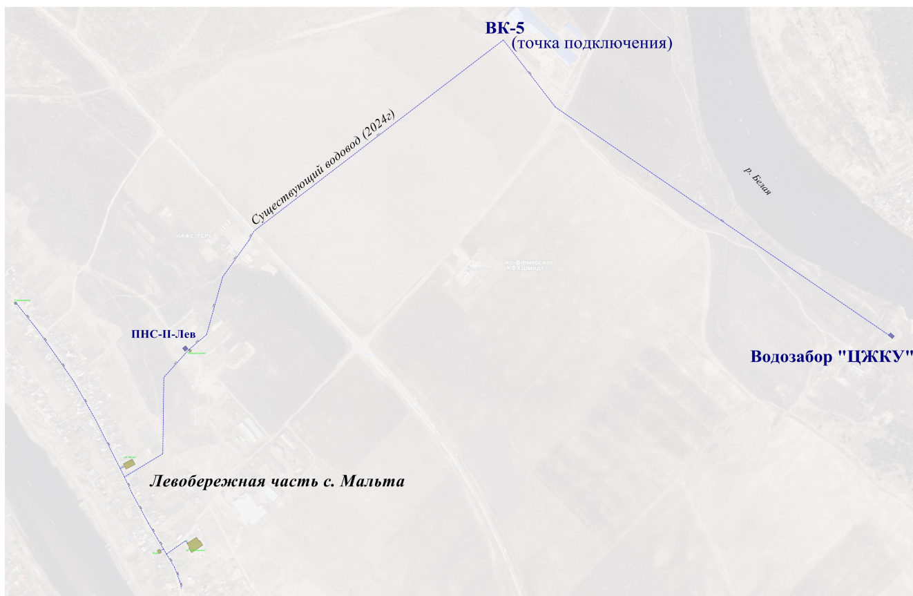
Рис. 2.1. Принципиальная схема перспективной централизованной системы ХВС левобережной части с. Мальта
